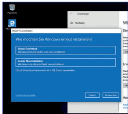
Das System wird neu installiert. Sie haben die Wahl zwischen einer lokalen Neuinstallation und einer Installation per Cloud-Download. Danach befindet sich das System wieder im ursprünglichen Auslieferungszustand. Nach der Installation haben Sie die Möglichkeit, eine zuvor erstellte Datensicherung wieder auf das System einzuspielen.
