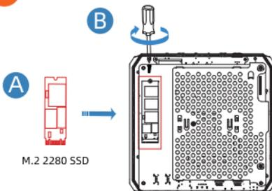
Setzen Sie die M.2 SSD (A) schräg von oben in den entsprechenden SSD-Slot ein und befestigen Sie sie mit der Arretierungsschraube (B).
