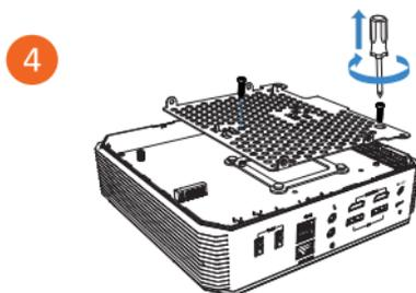
Lösen Sie die Befestigungsschrauben mit einem passenden Schraubendreher und nehmen die Festplattenhalterung heraus
