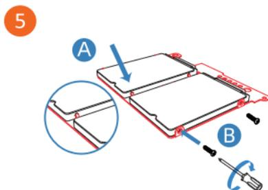
Setzen Sie die 2,5" SSD/HDD in die Festplattenhalterung ein und befestigen Sie die Festplatte mit passenden Schrauben an die Festplattenhalterung (die SSD/HDD sollte eine Höhe von 7 mm nicht überschreiten)
