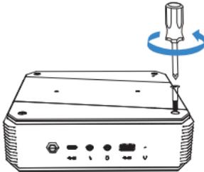
Um eine Aufrüstung durchzuführen, entfernen Sie die vier Gehäuseschrauben an der Unterseite des Mini-PCs mit einem passenden Schraubendreher.
