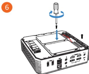
Befestigen Sie die Festplattenhalterung mit den dazugehörigen Schrauben wieder im Gehäuse und schließen Sie das SATA-Kabel an.
